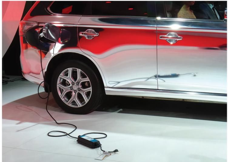
Один из вариантов зарядки ходовых батарей Outlander PHEV - с помощью стандартного зарядного устройства от обычной электросети
