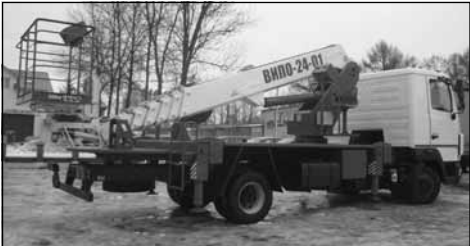
АГП ВИПО-24 , автовышка, телескопическая, шасси МАЗ 4x2, г/п 300кг, раб. высота 24 м, раб. радиус 14 м, поворот стрелы 360 град, официальный дистрибьютор, гарантия, сервис, запчасти, новый 8-727-253-03-02, 8-701-952-60-32,8-701-925-00-33,8-701-925-00-44
