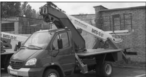
АГП ВИПО-18 , автовышка, телескопическая, шасси Валдай 4x2, г/п 240кг, раб. высота 18м, раб. радиус 12.5 м, поворот стрелы 360 град, официальный дистрибьютор, гарантия, сервис, запчасти, новый 8-727-253-03-02, 8-701-952-60-32,8-701-925-00-33,8-701-925-00-44
