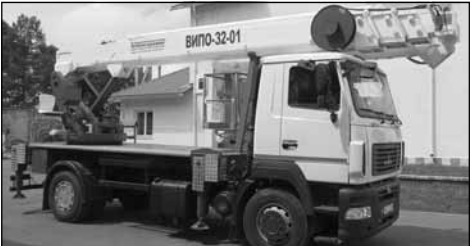
АГП ВИПО-32 , автовышка, телескопическая, с гуськом, шасси МАЗ 4x2, г/п 300кг, раб. высота 32м, раб. радиус 21 м, поворот стрелы 360 град, официальный дистрибьютор, гарантия, сервис, запчасти, новый 8-727-253-03-02, 8-701-952-60-32,8-701-925-00-33,8-701-925-00-44
