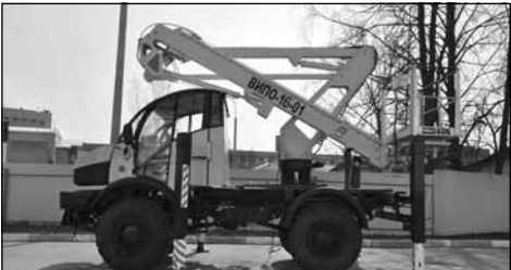
АГП ВИПО-16 Силант , автовышка, рычажно-телескоп., 4x4, г/п 240кг, раб. высота 16м, раб. радиус 8.5 м, поворот стрелы 360 град, официальный дистрибьютор, гарантия, сервис, запчасти, новый 8-727-253-03-02, 8-701-952-60-32,8-701-925-00-33,8-701-925-00-44
