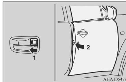
Установите внутреннюю кнопку запираения двери (1) в положение «запереть» и закройте дверь (2).
