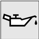
Эта лампа включается при повороте ключа зажигания в положение ON или включении режима работы ON и выключается после запуска двигателя. Если она включается во время работы двигателя, это говорит о слишком низком давлении масла.
