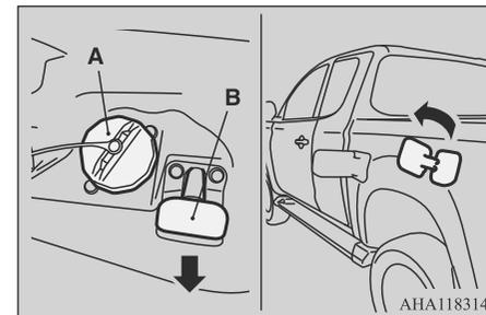
4. Откройте заливную горловину бака для реагента AdBlue™, медленно поворачивая крышку против часовой стрелки.
