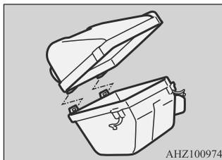
2. Чтобы заменить лампу левой фары, снимите крышку блока предохранителей, нажав на защелку (D).
