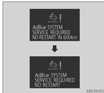
При наличии неисправности в системе в зависимости от ситуации в информационном окне многофункционального дисплея отобразится соответствующее предупреждающее сообщение. В то же время на щитке приборов начнет мигать контрольная лампа
