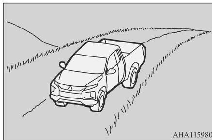
Установите переключатель режимов движения в положение 4Н или 4L (система полного привода Easy Select 4WD) либо в положение 4HLc или 4LLc (система полного привода Super Select 4WD II), используйте торможение двигателем (понижение передачи) и медленно двигайтесь под уклон.
