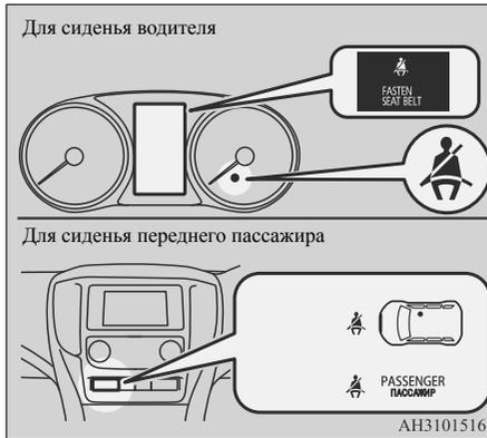
Если повернуть ключ в замке зажигания в положение ON или включить режим работы ON, когда ремень безопасности водителя и (или) переднего пассажира не пристегнут, начинает мигать контрольная лампа и примерно на 6 секунд включается звуковой сигнал, напоминая водителю и (или) переднему пассажиру о необходимости пристегнуться.
