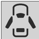
Эта лампа включается, если какая-либо дверь открыта или неплотно закрыта. Если какая-либо дверь открыта или неплотно закрыта, а авто-
