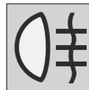
Эта контрольная лампа включается при включении заднего противотуманного фонаря.
