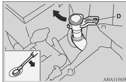
3. Поверните крышку (Е) против часовой стрелки и затем снимите ее.
