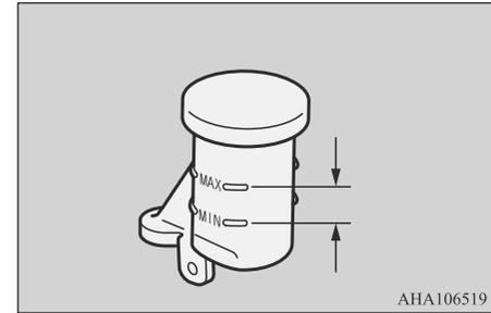
Быстрая потеря жидкости указывает на утечку в контуре гидропривода сцепления. Автомобиль следует немедленно проверить и отремонтировать в авторизованном сервисном центре MITSUBISHI MOTORS.
