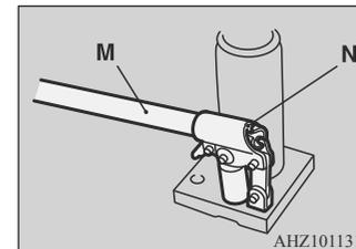
12. Вдавите шток до упора и затяните выпускной клапан, заворачивая его по часовой стрелке.
