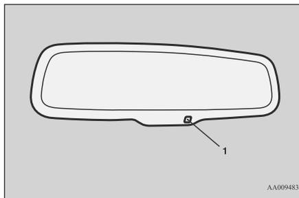
При повороте ключа зажигания в положение ON или включении режима работы ON автоматически изменяется коэффициент отражения зеркала.
