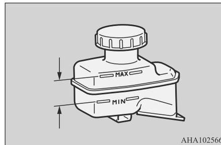
Уровень тормозной жидкости контролируется поплавковым датчиком. Если уровень тормозной жидкости опускается ниже отметки MIN, включается контрольная лампа уровня тормозной жидкости.
