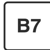
B7: дизельное топливо, содержащее до 7 % (объемное содержание) метиловых эфиров жирных кислот в соответствии со стандартом EN 590
