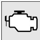
Эта лампа является компонентом бортовой системы самодиагностики, контролирующей состав отработавших газов и работу систем управления двигателя, избирательной каталитической нейтрализации
