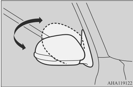
**Автомобили с электроприводом складывания наружных зеркал заднего вида**
