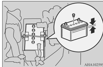
Уровень электролита должен находиться между отметками, расположенными снаружи на корпусе батареи. При необходимости долейте дистиллированную воду.
