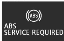
При неисправности в системе ABS включается контрольная лампа ABS, а на многофункциональном дисплее появляется предупреждающее сообщение.
