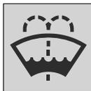
Эта лампа включается при малом уровне жидкости в бачке стеклоомывателя. Если лампа включилась, долейте жидкость в бачок стеклоомывателя.
