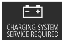
При возникновении неисправности в системе зарядки аккумуляторной батареи на многофункциональном дисплее отображается предупреждающее сообщение. Также включается контрольная лампа на панели приборов.
