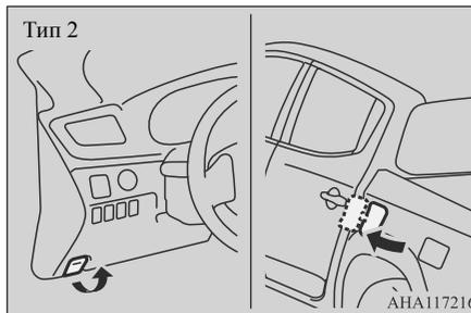
3. Потяните за рычаг (B) с правой стороны крышки (A) заливной горловины топливного бака, чтобы открыть лючок заливной горловины бака для реагента AdBlue™.
