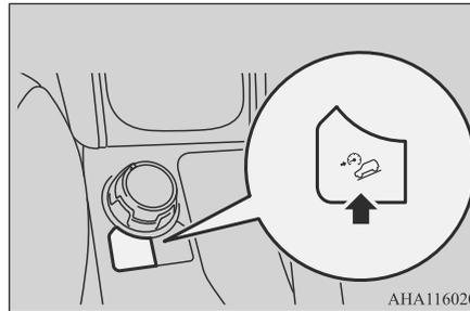
4. Убедитесь во включении контрольной лампы системы помощи при спуске по склону. Включение контрольной лампы системы помощи при спуске по склону указывает на то, что система находится в состоянии готовности.
