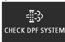
При отклонениях в работе фильтра твердых частиц в процессе движения автомобиля включается контрольная лампа фильтра твердых частиц и контрольная лампа диагностики двигателя или на дисплее появляется предупреждающее сообщение фильтра твердых частиц и включается контрольная лампа диагностики двигателя.
