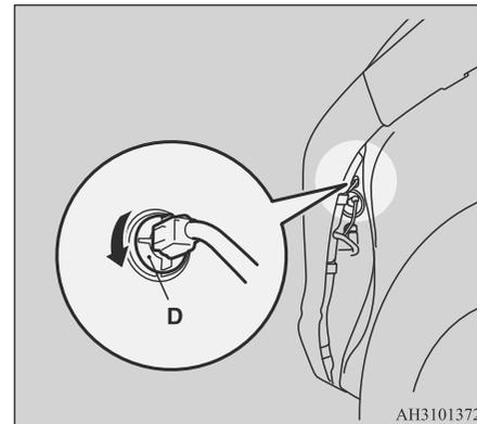
4. Лампа устанавливается в порядке, обратном порядку снятия.
