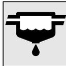
Эта контрольная лампа включается при повороте ключа зажигания в положение ON или включении режима работы ON и выключается после запуска двигателя. Если контрольная лампа включается
