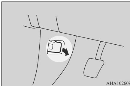
2. Поднимите капот, нажав на рычаг предохранительного крюка.
