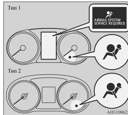
Контрольная лампа SRS находится на приборной панели. Система выполняет самодиагностику при каждом повороте ключа зажигания в положение ON или включении режима работы ON. Контрольная лампа SRS включается на несколько секунд, затем выключается. Это не является признаком неисправности и свидетельствует о нормальной работе системы.
