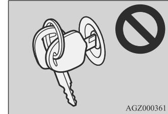
В этом случае снимите с ключа посторонний предмет или другой ключ. После этого снова попытайтесь запустить двигатель. Если двигатель не запускается, рекомендуется обратиться в авторизованный сервисный центр MITSUBISHI MOTORS.
