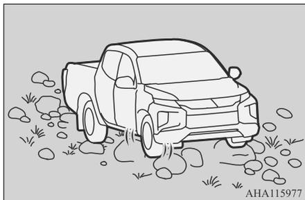
Включите режим 4Н или 4L (Easy Select 4WD) либо 4HLc или 4LLc (Super Select 4WD II), затем двигайтесь на низкой скорости. В зависи-
