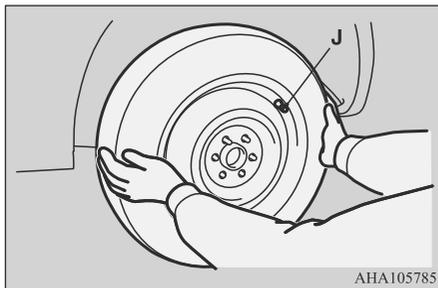
8. Заверните колесные гайки по часовой стрелке и предварительно затяните их от руки.
