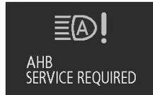
При неисправности датчика
