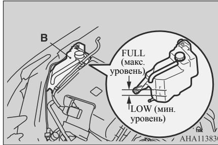
5. При необходимости долейте в радиатор и (или) в расширительный бачок охлаждающую жидкость (см. главу «Техническое обслуживание автомобиля»).
