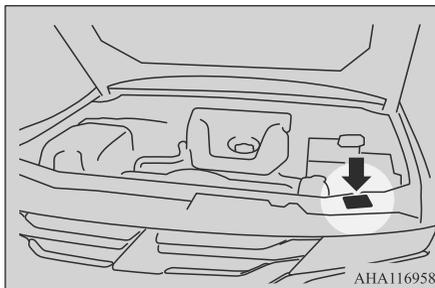
На табличке указаны код модели автомобиля, модель двигателя, модель коробки передач, код цвета кузова и т. д. При заказе запасных частей пользуйтесь указанными кодовыми номерами.
