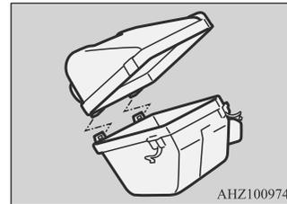
2. Чтобы заменить лампу с левой стороны, извлеките пистон (D), поддерживая горловину бачка омывателя, затем сдвиньте горловину в направлении задней части автомобиля.
