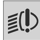
Эта контрольная лампа на панели приборов включается при наличии неисправности светодиодных фар.
