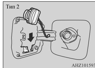
4. Вставляйте заправочный пистолет как можно глубже внутрь заливной горловины топливного бака.
