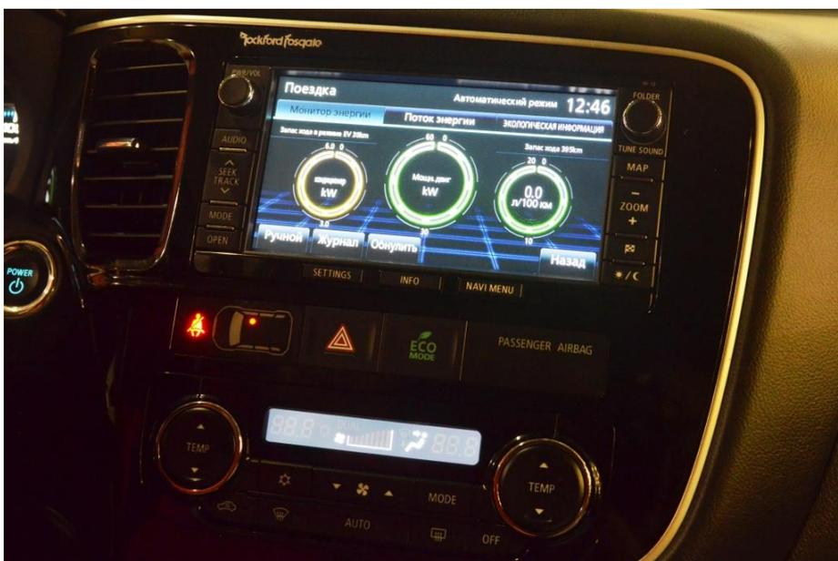
В «Последовательном режиме» автомобиль по-прежнему приводится в движение передним и задним электромоторами ДВС подключается автоматически только для привода генератора, который «на ходу» заряжает батарею. Режим включается автоматически максимум на 3-10
